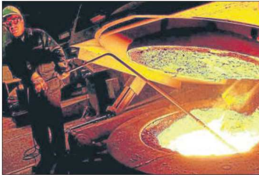
Hasenclever: Mit einer Sonde ermittelt ein Mitarbeiter die Temperatur in einem elektrisch betriebenen Eisenofen. Archivfoto: Pries
